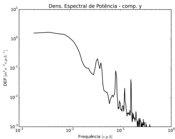
**APÊNDICE 4.2.H.** Espectros de energia ( $\text{m}^2 \text{s}^{-2} \text{cph}^{-1}$ ) das componentes normal (u, painel superior) e paralela (v, painel inferior) à isóbata do vetor velocidade observado no meio da coluna de água, em LS2.
